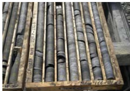
Anhand der Gesteinsproben aus der Tiefe kann der Verlauf der Flöze definiert werden.
